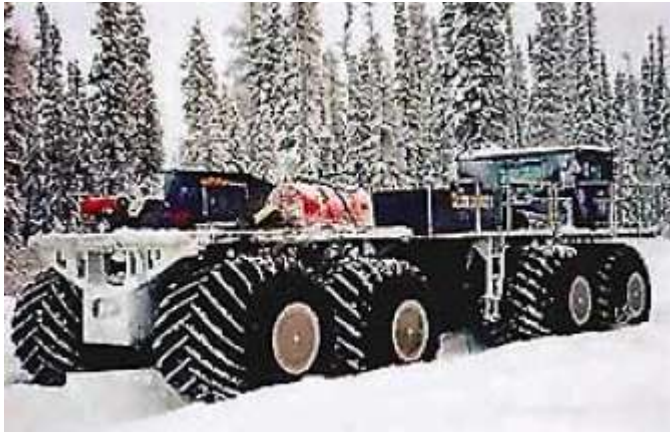
Rolligon 8x8 Super Brute (42,5 ton capacity)
